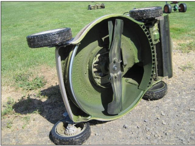
Figura 9. Un cortacésped triturador dispone de dos cuchillos que le permite picar los restos de pasto.
