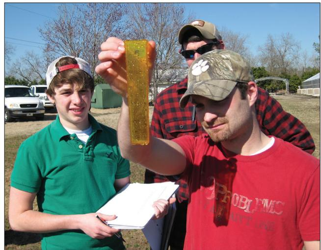
Figura 11. Utilice pluviómetros u otros recipientes para calcular la tasa de aplicación (pulgadas por hora). No se debe aplicar más de 0.5 pulgada durante un turno de riego.
