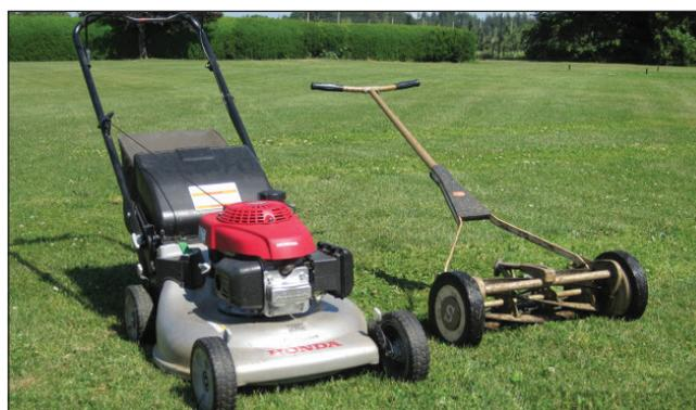
Figura 8. Los cortacéspedes rotativos (izquierda) son duraderos, pero típicamente tienen una altura de corte mínima de 1 pulgada. Los cortacéspedes manuales (derecha) por lo general tienen una altura de corte máxima de 2 pulgadas.
